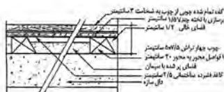
اجرای کف پوش چوبی
